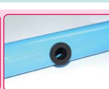
นำลูกยาง D-GR สวมเข้าไปในรูที่เจาะ
