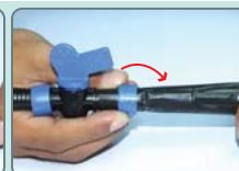
หมุนคลิปล็อกออกมาให้สุด เพื่อล็อกเทปน้ำหยด
