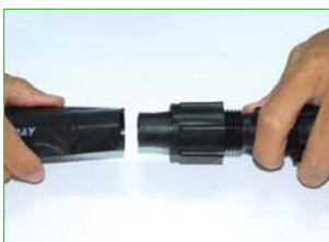
นำเทปน้ำพุ่งมาสวมที่ข้อต่อ โดยหันด้านที่มีรูน้ำขึ้นด้านบน
