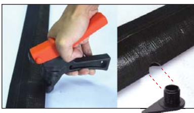
ใช้ตัวเจาะ HPL (หน้า 12) เจาะรูยังตำแหน่งที่ต้องการติดตั้งเทปน้ำหยดแยกจากท่อแบบ
