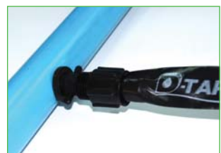
นำเทปน้ำพุ่งสวมเข้ากับข้อต่อ โดยหันด้านรูน้ำขึ้น และขันฟาล็อกให้แน่น
