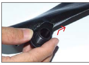
สอดข้อต่อที่เตรียมไว้เข้าไป โดยเอา ด้านแหลมเข้า ดังรูป
